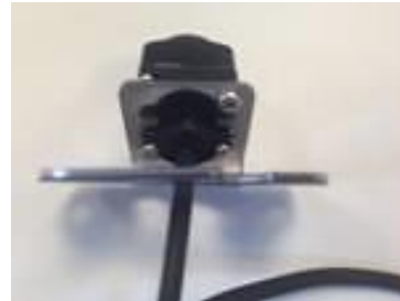
Kamera in Haltung um 180° gedreht
