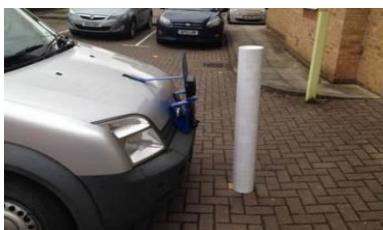
1 m lange Stange vor der Kamera auf 0,6 m Höhe
